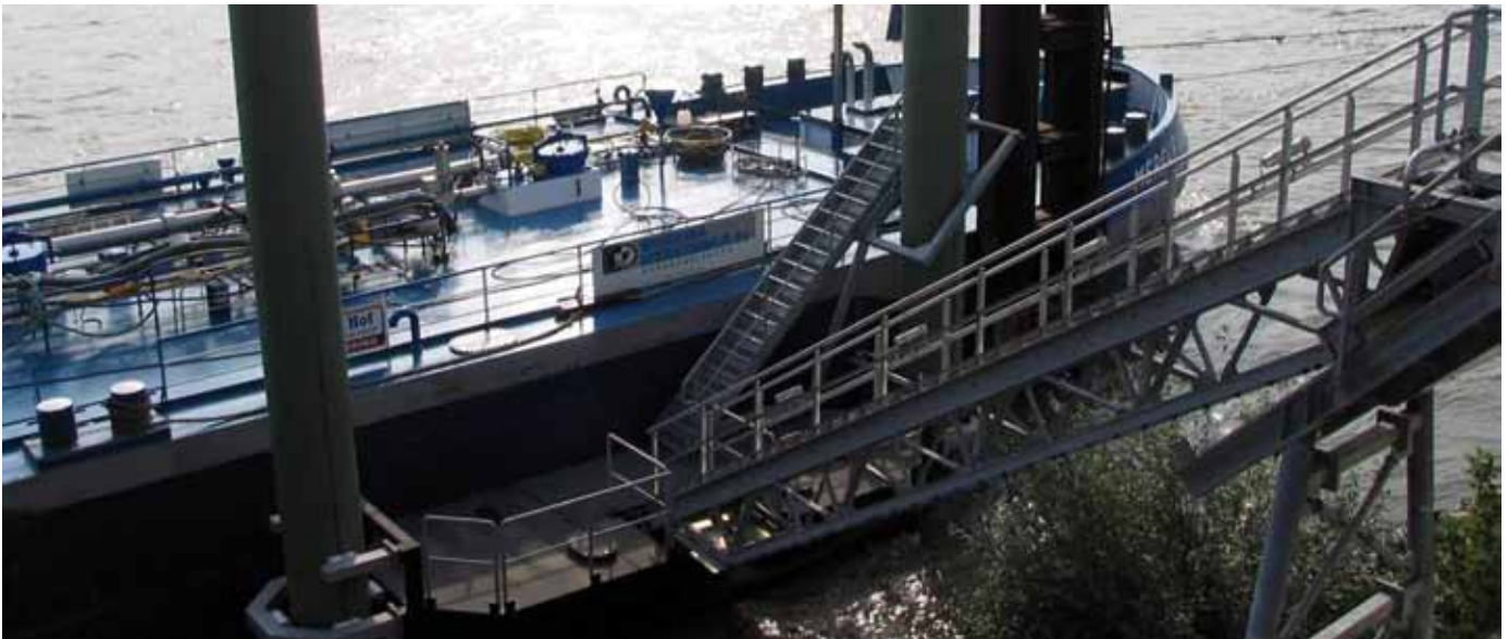
Sicherer Fluchtweg vom Vorschiff auch bei wechselnden Wasserständen im Stromhafen
