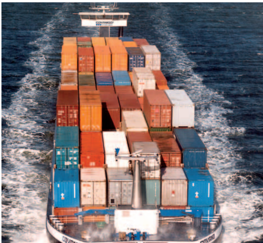
Wirtschaftsgüter werden immer häufiger in Standardcontainern per Binnenschiff aus den Seehäfen wie Amsterdam, Rotterdam, Antwerpen oder Hamburg in das Hinterland befördert. Ein modernes Binnenschiff kann bis zu 500 TEU transportieren. Foto: Contargo
