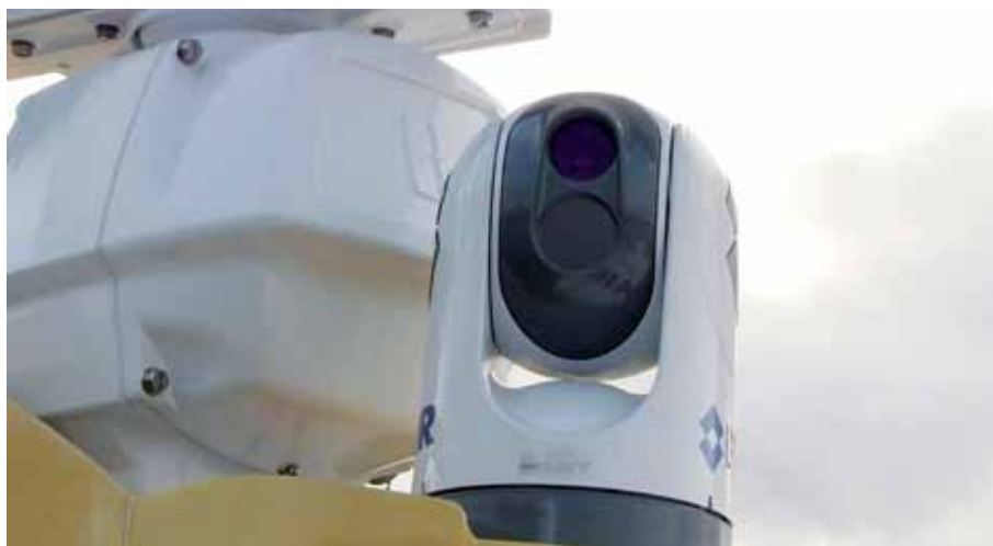
Eine Wärmebildkamera kann als Ergänzung des Radargerätes dienen. Foto: Trauthoff Anzeige
