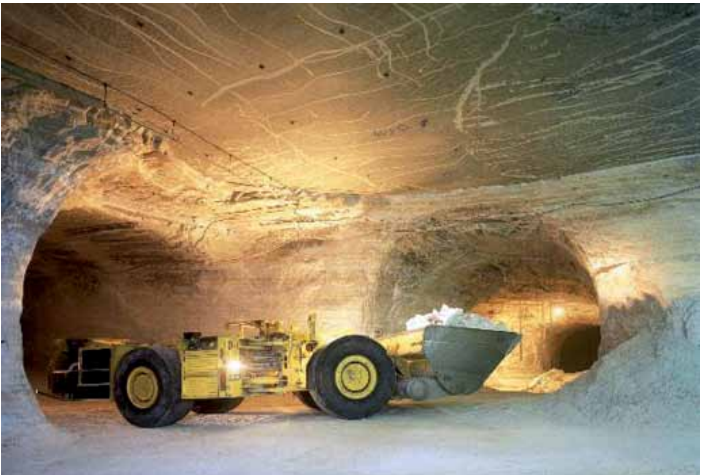
Bis zu 17 Tonnen Rohsalz kann dieser Lader auf einmal transportieren. Die wertvollen Rohstoffe werden auf den Standorten der K+S KALI GmbH zu hochwertigen Düngemitteln und Industrieprodukten verarbeitet. Foto: KS AG
