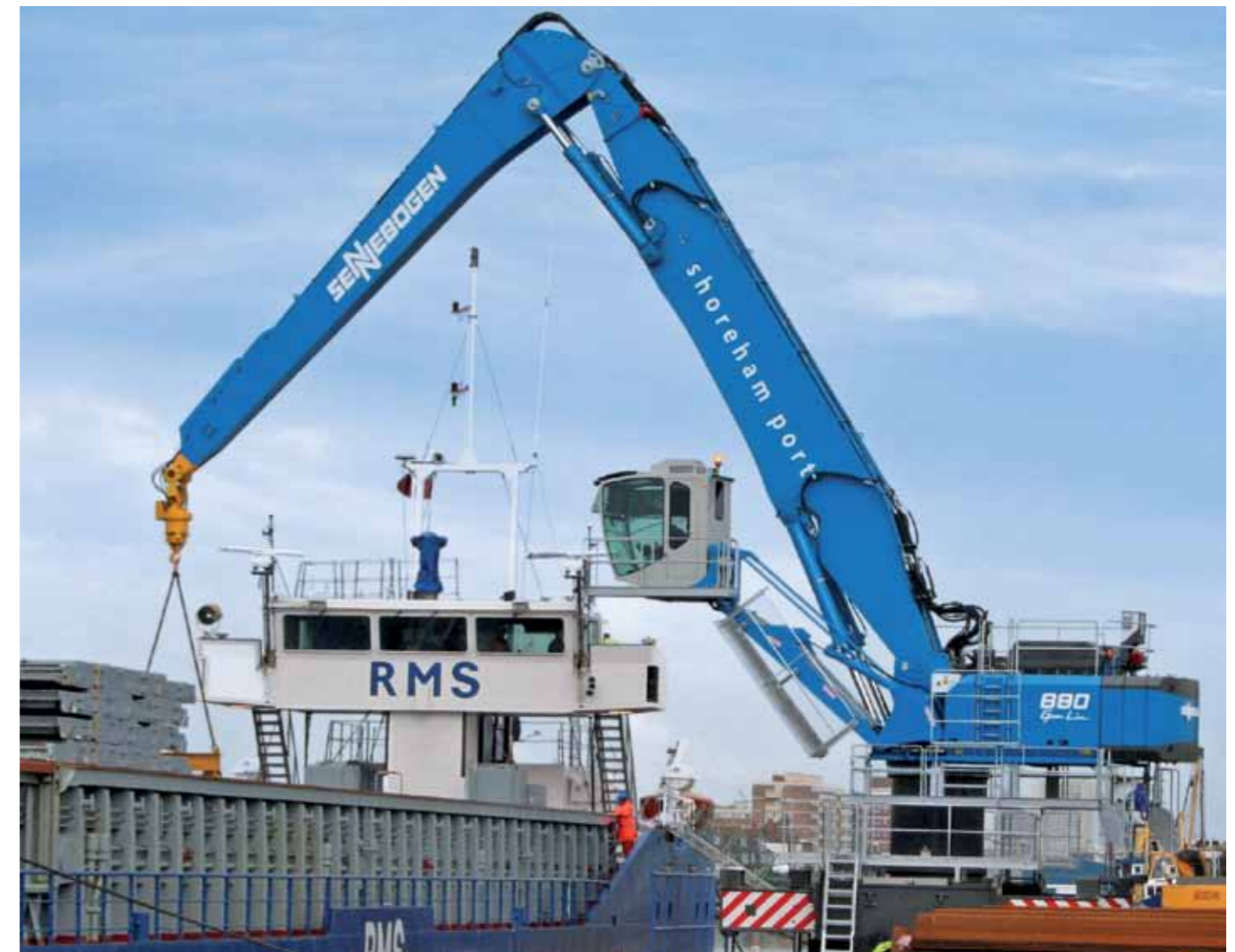
Sennebogen 880 Mobil - ein Gigant auf Rädern. Die weltweit größte mobile Materialumschlagmaschine im Einsatz bei Löschen eines Fluss-See-Schiffes der Duisburger Reederei RMS im britischen Shoreham Port.
