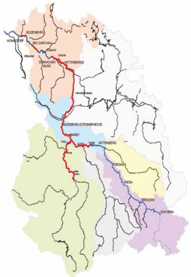
Abb. 5.2: Juni 2013: Überschreitungen des HHW (höchster gemessener Wasserstandswert) seit Pegeleinrichtung im Verlauf der Bundeswasserstraßen Elbe und Saale (rote Kennzeichnung)
