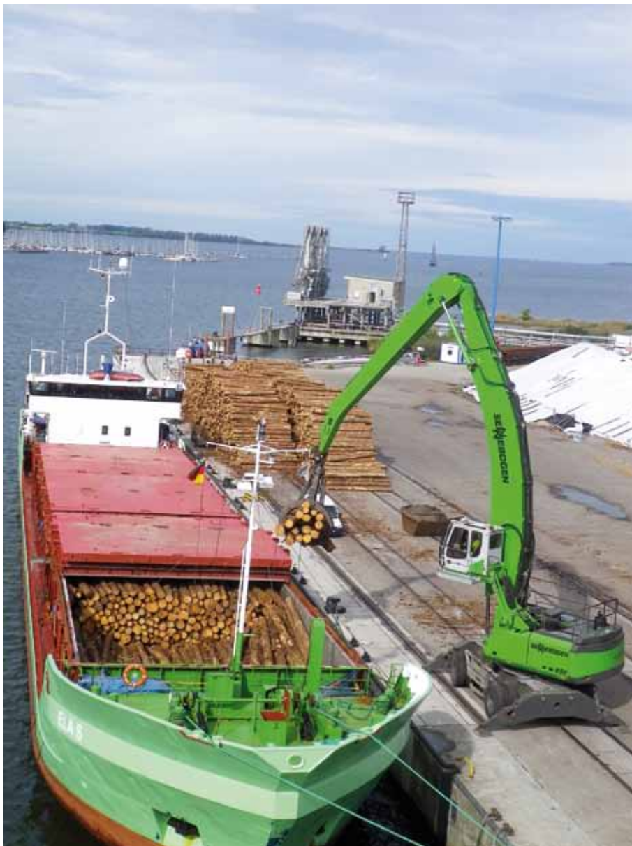
Ein neuer Sennebogen 870 M spezial arbeitet seit kurzem im Seehafen Wismar und schlägt bis zu 140 t Rundholz pro Stunde auf LKW um.
