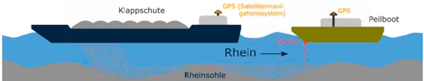
Schiffe mit geteiltem Laderaum und Ortungsgeräten – sogenannte Klappschuten – brachten das Gestein ins Wasser.
