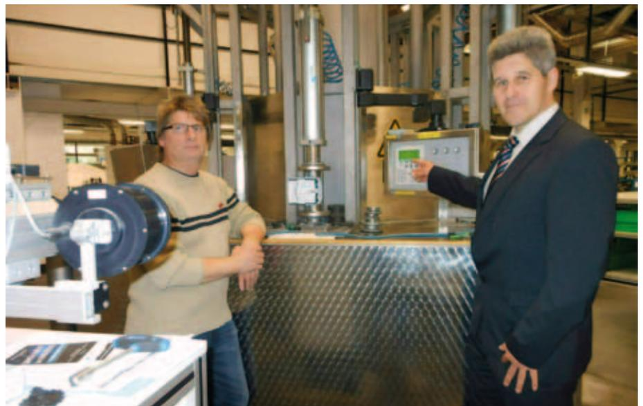
**Werner Blech und Volker Lenz (v. l.) bei der Kalibrierung von Durchfluss-Messgeräten. Eine Kamera stellt die Zeigerstellung bei verschiedenen definierten Durchflussraten (z.B. 5, 10 und 20 l/h) fest. Anhand dieser Werte wird dann die Skala für das Messgerät individuell gedruckt.**
