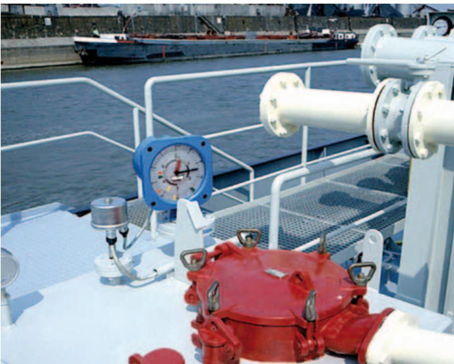
*Alte Füllstandsuhr an Deck eines Tankschiffs .*
