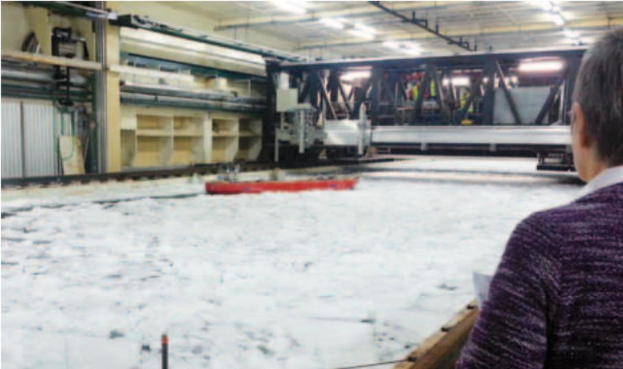
Im Eistank können Modellschiffe mit Modelleisdicken bis zu 8 cm getestet werden
