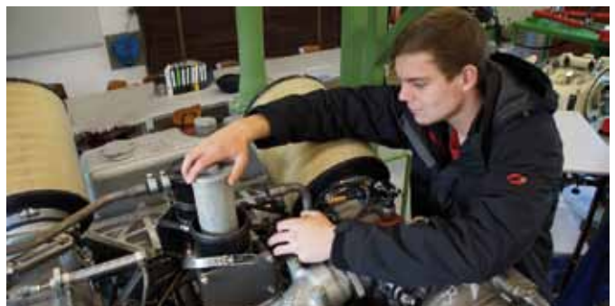
Christian Storm wechselt einen Filter der Kurbelwellenraumentlüftung.
