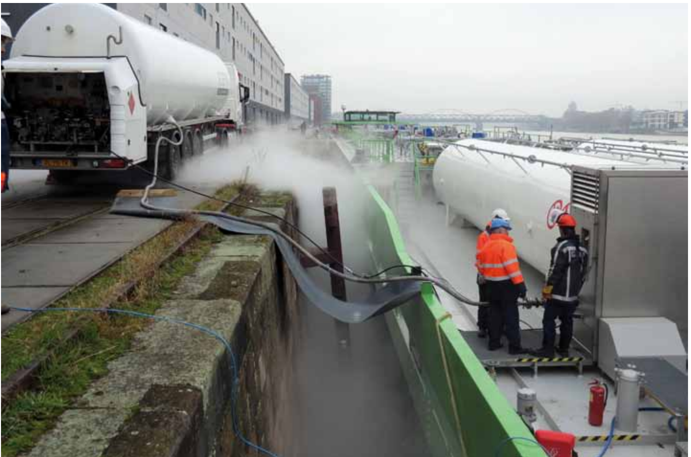
Die Greenstream ist das erste Tankschiff, das in in einem deutschen Hafen mit LNG versorgt wurde. Wer anhand des Fotos vermutet, das Schiff läge in Mannheim mit dem Kopf zu Tal, irrt, - die Greenstream hat das Ruderhaus auf dem Vorschiff, liegt also mit dem Kopf zu Berg (fb). Foto: Hafen Mannheim
