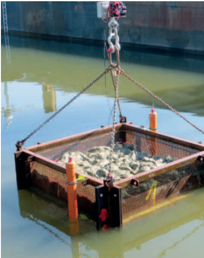
Herstellung des Probekörpers für Verguss unter Wasser
