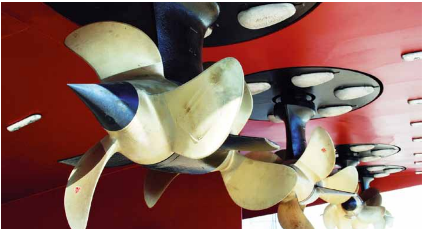
Über 40 Flusskreuzfahrtschiffe in Europa sind mit dem Schottel Antriebskonzept aus vier Schottel Twin Propellern STP 200 ausgerüstet oder befinden sich noch im Bau. Foto: Schottel
