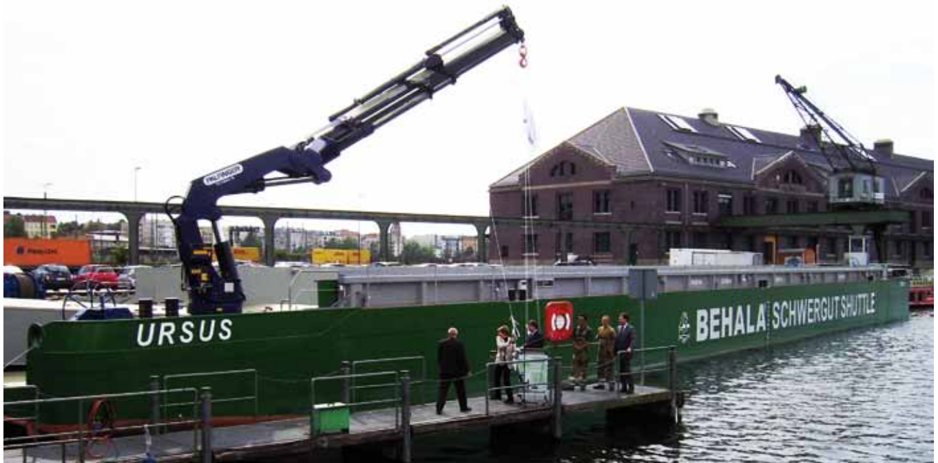
Taufe des neues Leichters durch Behala-Prokuristin Cornelia Röser. Um den Leichter passgenau manövrieren zu können, ist ein Bugstrahlruder mit einer Leistung von 265 kW installiert. Der Propeller kann aus dem Tunnel des Bugstrahlruders abgesenkt werden und als 360 Grad schwenkbare Einheit unterstützend als Hilfsantrieb sowie als Notfalantrieb eingesetzt werden. Foto: Sabo Krebs
