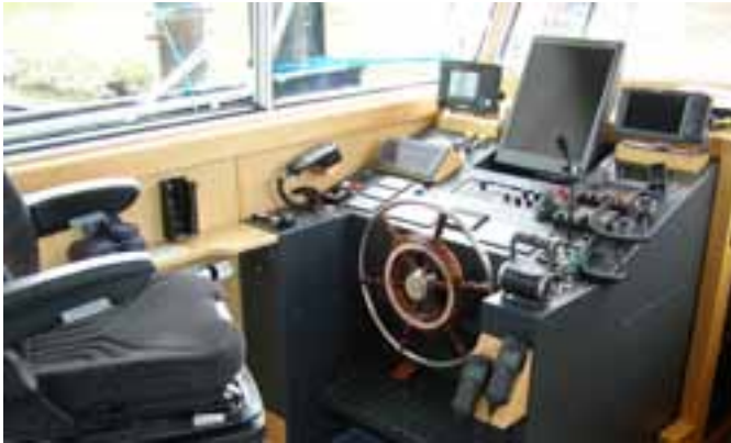
Der Fahrstand des Polizeistreifenbootes 3 mit Tageslichtradar und Radar-pilotanlage mit GPS-Unterstützung.
