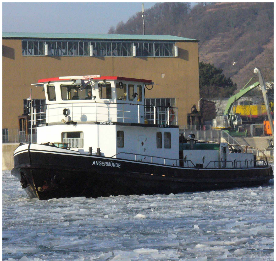
Eisbrecher ANGERMÜNDE des WSA Schweinfurt, Bj. 1958 in Brandenburg als EINHEIT für die VEB Binnenreederei der DDR, 560 PS, 30,10 x 7,35 m. Seit 1990 nach Umbau beim WSA Schweinfurt. Foto: K. Krüger
