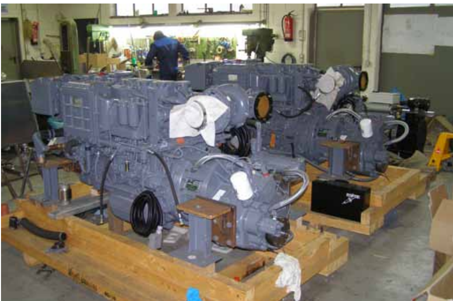
Die 6 Zylinder MAN-Dieselmotoren mit je 412 kW für das HLB HECHT.
