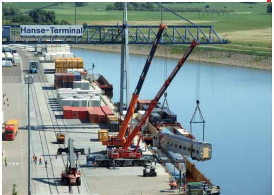
**Im Hansehafen wurde die aus Spanien gelieferte Eisenbahn per mobilem Kran aus dem Schubverband gehoben.**
