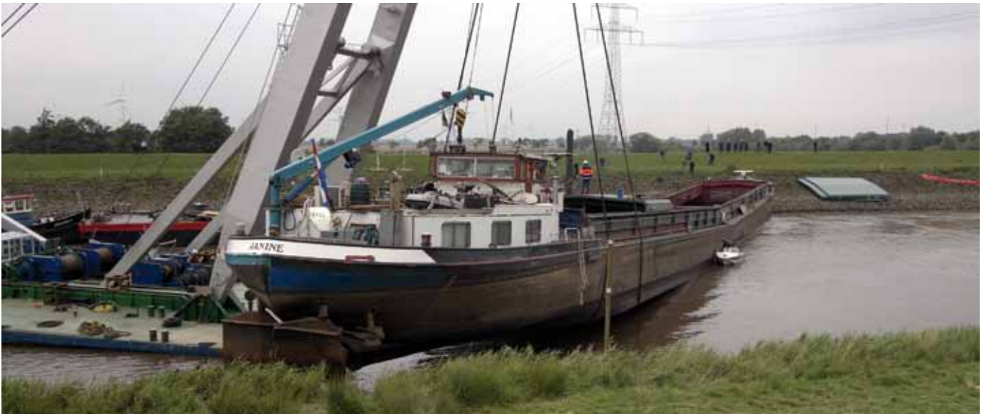
Die durchgebrochene „Janine“ im Fahrwasser der Hunte.
