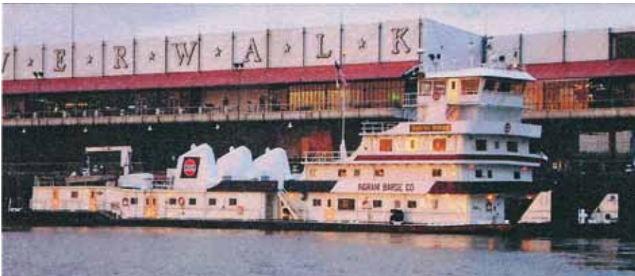
Das Mississippi-Schubboot „Martha Ingram“ ist 61 m lang und 16,5 m breit. Bei den Hauptmaschinen handelt es sich um drei EMD 20-645 Dieselmotoren mit einer Leistung von insgesamt 10.650 PS (7.830 kW). Die drei Propeller haben einen Durchmesser von je 2,90 m. Das Schubboot wurde 1978 in der St. Louis Shipyard gebaut.
