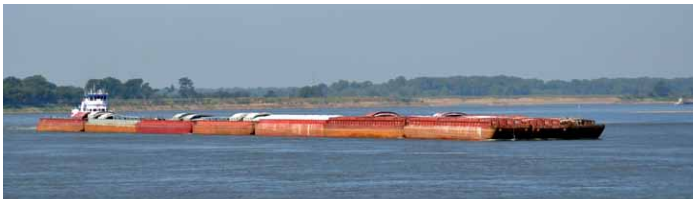
Schubverband mit 21 Leichtern á 1.600 t Tragfähigkeit auf der Mississippi-Bergfahrt vor Memphis/Tennessee. Foto: Friedbert Barg
