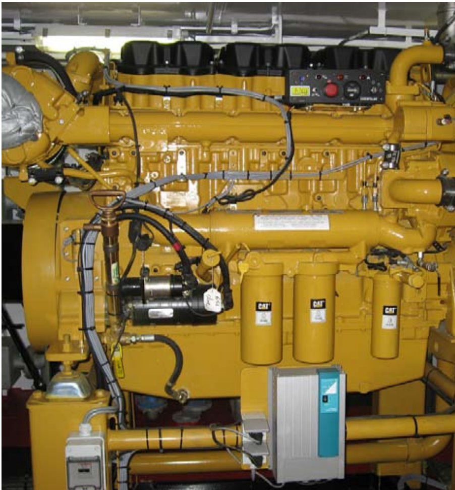
MS „LOMA“ ist mit einer Caterpillar-Hauptmaschine vom Typ 6 DZC-1000-116A ausgestattet, die 1.835 PS bei 1.620 UpM leistet
