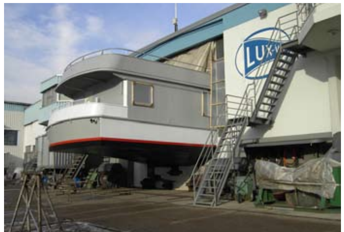
Abb. 4: „Seehausen“-Hinterschiff „wächst“ aus der Schiffbauhalle. Foto: Volker Renner
