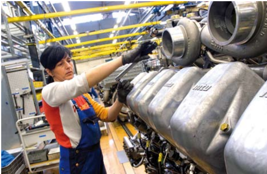
Für den Einsatz in der Binnenschifffahrt kommen hauptsächlich die Motoren der 4000er Baureihe in Betracht. Hier ein Bild von der Montage eines Motors dieser Baureihe.
