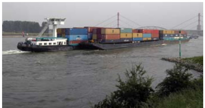
Abb. 9: Motorschiff-Schubverband mit drei Leichtern, Container-Staukapazität ca. 688 TEU Foto: V. Renner
