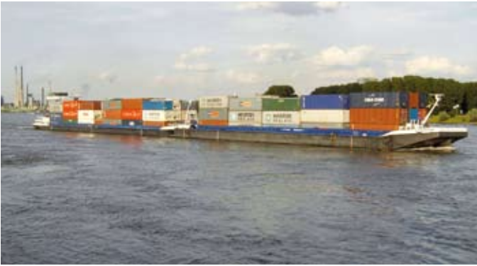
Abb. 6: Motorschiff-Schubverband mit einem Leichter, Container-Staukapazität ca. 368 TEU Foto: V. Renner
