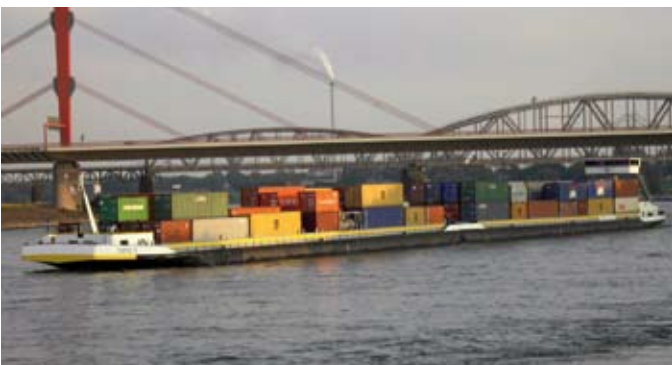
Abb. 7: Motorfrachtschiff-Schubverband mit klassischem Vor- und Hinterschiff, Container-Staukapazität ca. 368 TEU
