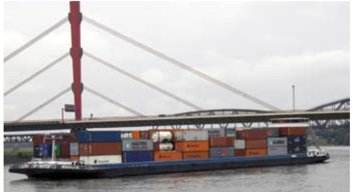
Abb. 8: 135 m x 17,50 m – Schiff (JOWI-Klasse), Container-Staukapazität ca. 508 TEU Foto: V. Renner
