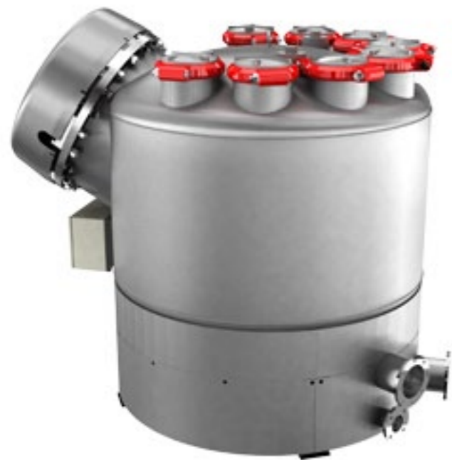
Wärtsilä BWT 500i, die bahnbrechende integrierte Ballastwasser-Aufbereitung von Wärtsilä kombiniert beides in einer Einheit: die Filtration, sowie ultraviolette Desinfektionstechniken
