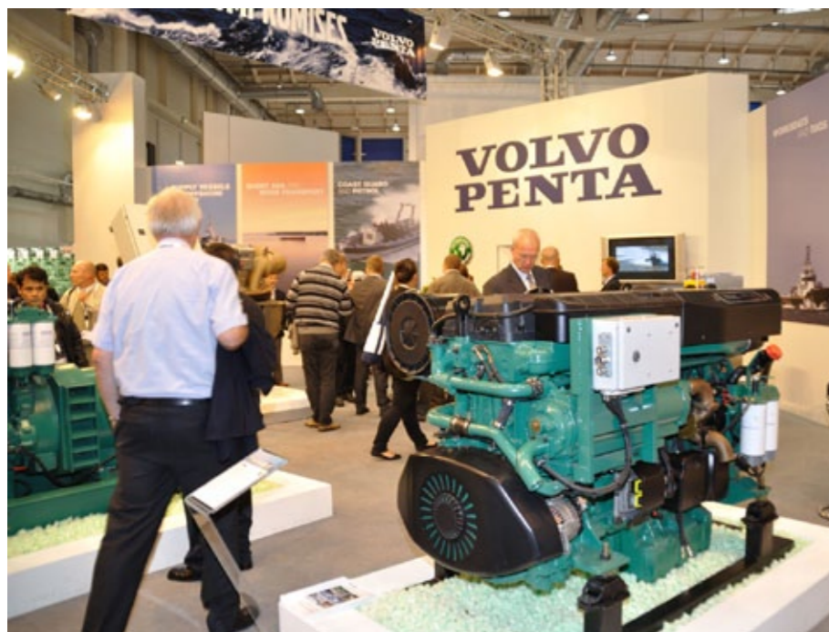
Volvo Penta zeigte den neuen D 13 Marine Commercial mit 700 und 800 Pferdestärken, geringeren Schadstoffemissionen und geringerem Treibstoffverbrauch. Foto: fb
