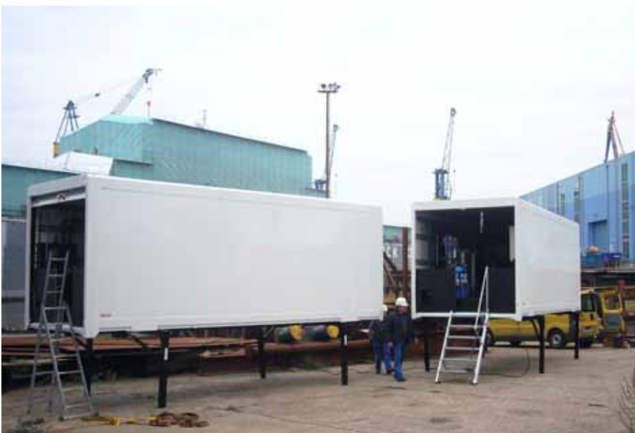
Die mobile Filterstation zur Aufbereitung der Prozessabwässer der Schiffsentlackung
