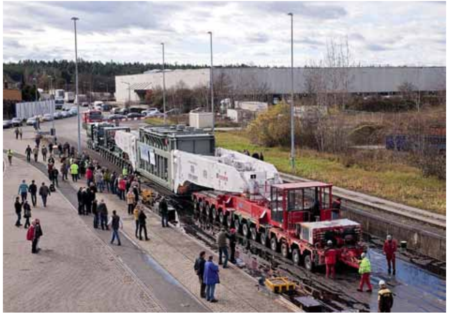
Der auf den Schwerlastponton gerollte Schwertransport am Schwergutkai Im Nürnberger Hafen. Foto: Siemens
